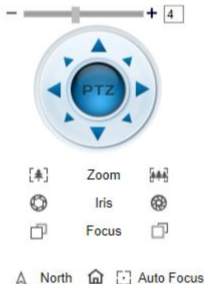
Figure 2-1 Zone de contrôle PTZ
